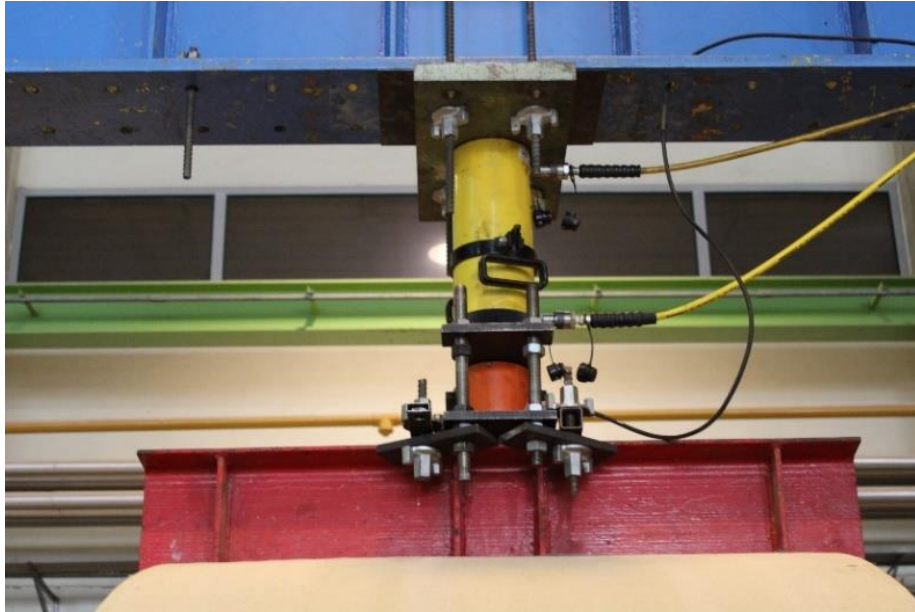
Figura 3.18 – Sistema de carga aplicado nos ensaios de flexão.
