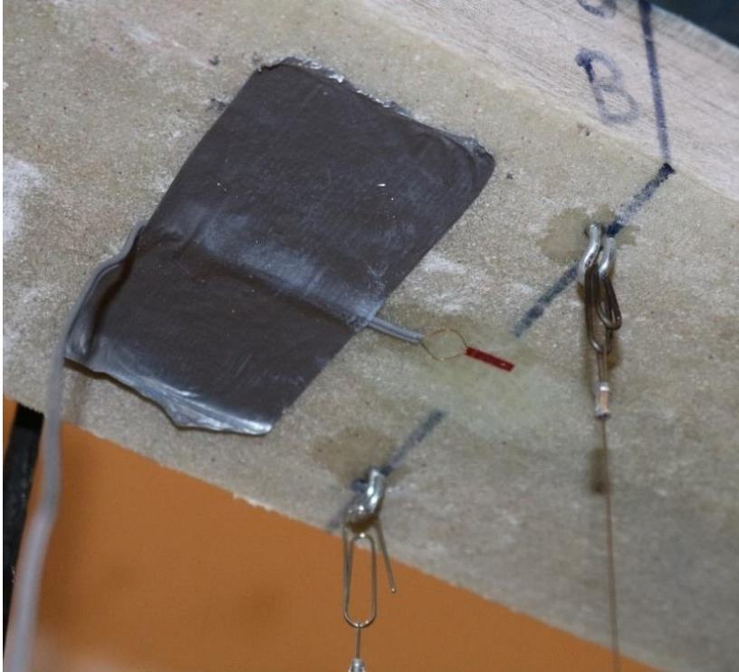
Figura C1 – Pormenor da instrumentação utilizada no ensaio de flexão.
