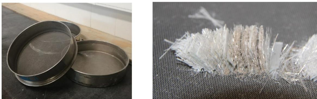
Figura 3.3 – Peneiros utilizados para separar a areia de quartzo das fibras de vidro (esquerda) e pormenor das camadas de fibra de vidro de um provete, antes da peneiração (direita).
