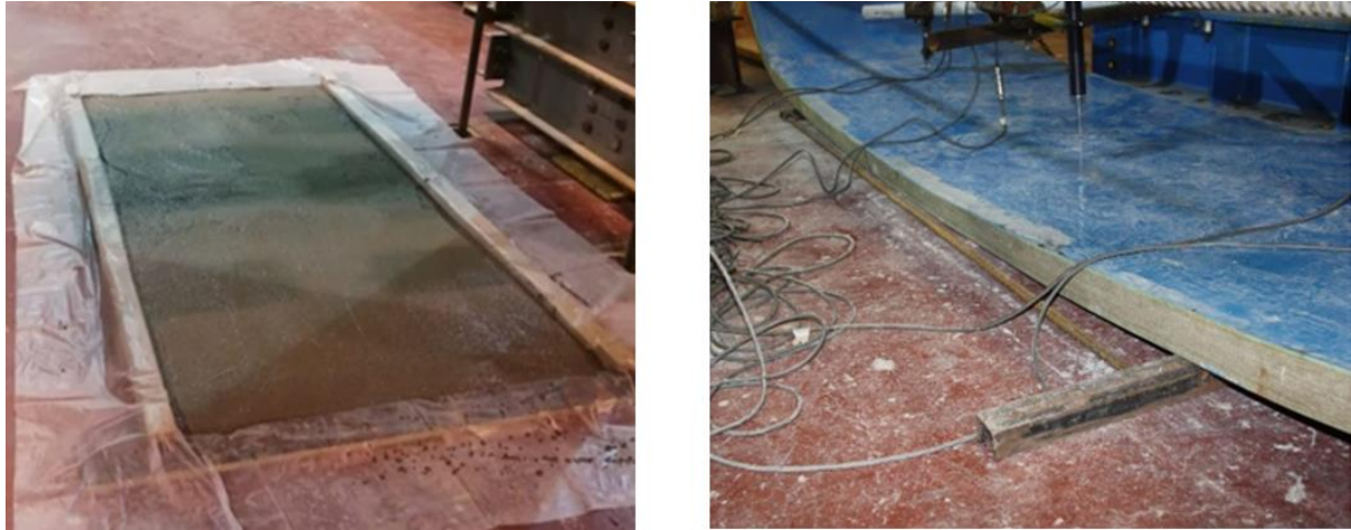
Figura 3.19 – Solução em grout usada para o provete PH1 (esquerda); solução com apoios fixos usada para os provetes PH2 e PH3 (direita).
