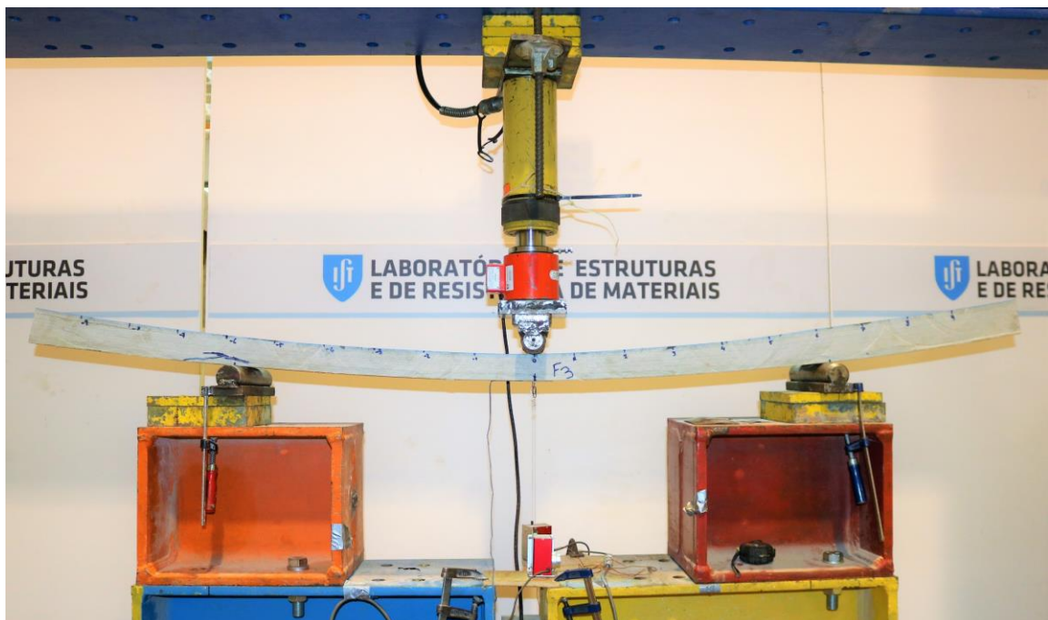
Figura 3.5 – Esquema do ensaio de flexão.
