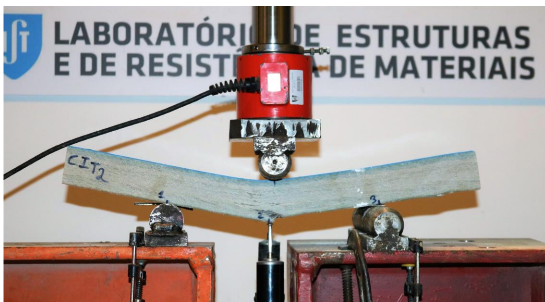
Figura 3.11 – Figura 3.14 Rotura por tracção CI_T2.
