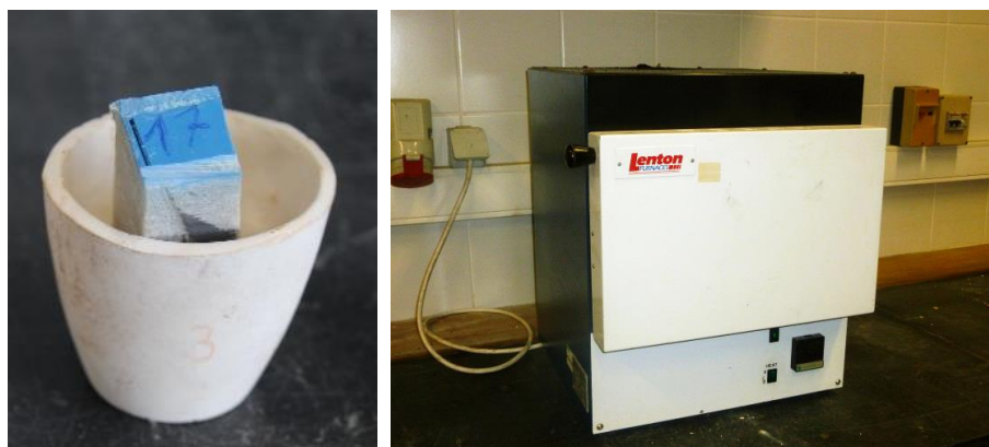
Figura 3.2 – Provete colocado no cadinho de alumina e mufla usada para a calcinação.
