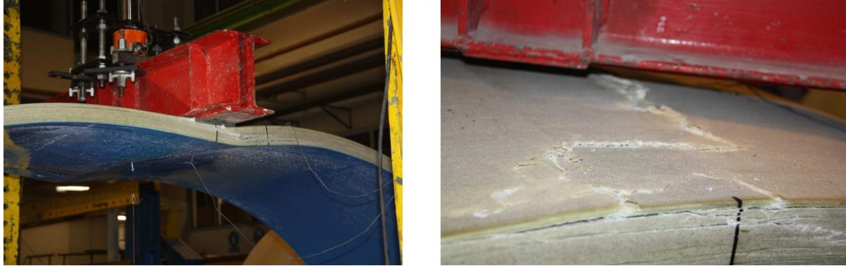
Figura 3.27 – Modo de rotura do provete PH2.
