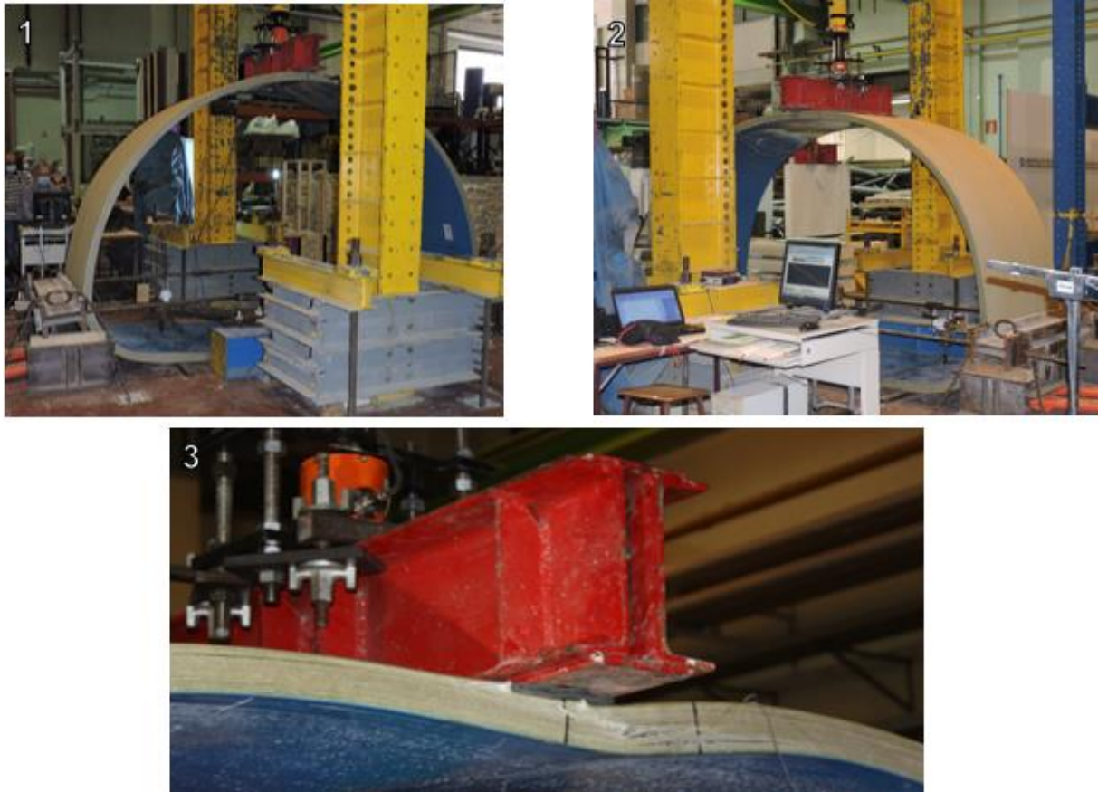
Figura 3.32 – Esquema ilustrativo das várias fases de ensaio do provete PH3: 1 – Início do ensaio; 2 – Momento antes da rotura; 3 – Após ser atingida a rotura.
